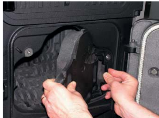
Fig. 14 Démontage de la grille
