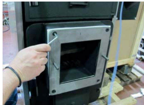
Fig. 23 Bride fixée à la porte de la chambre de combustion
